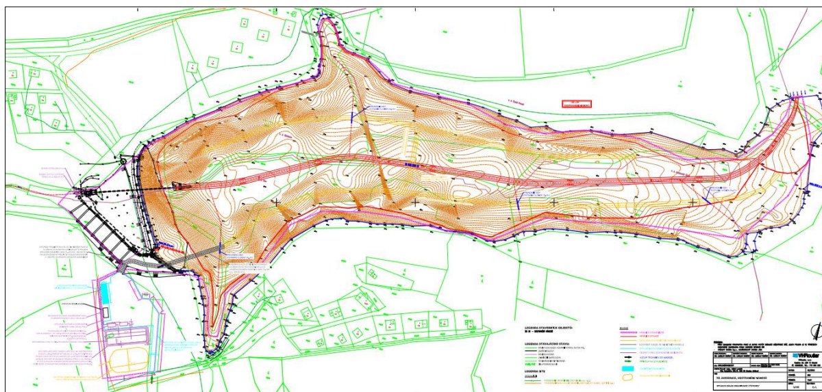
Obr. 1. VD Jahodnice, odstranění nánosů. Situace zásad organizace výstavby. VHRoušar, s.r.o.
